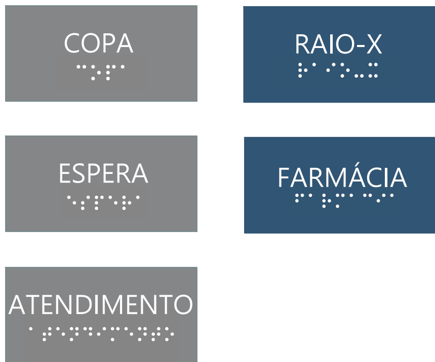
02 AMPLIAÇÃO 1 - PLACA DE PORTA BRAILLE -TIPO D01 ESCALA 1/2
